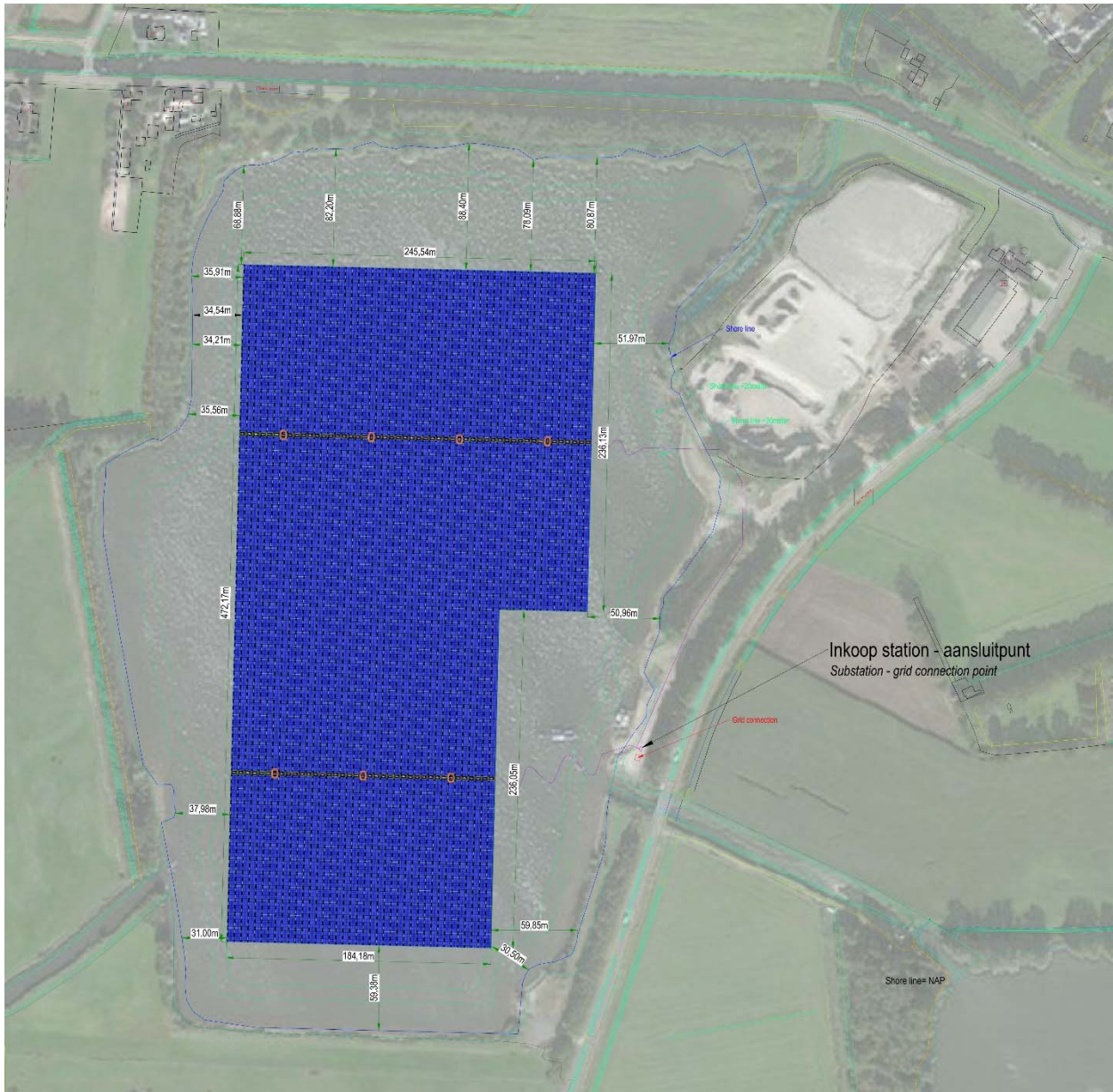
Figuur 2.3: Lay-out van het drijvende zonnepark (bovenaanzicht).
