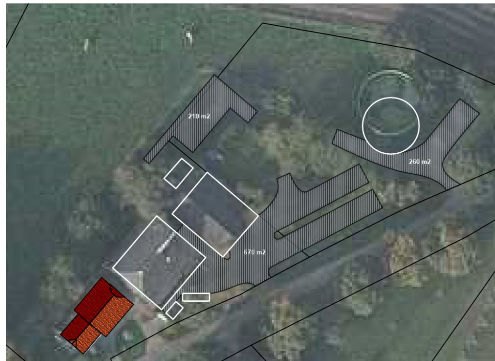
Figuur 12. Te verwijderen verharding 1.140 vierkante meter
