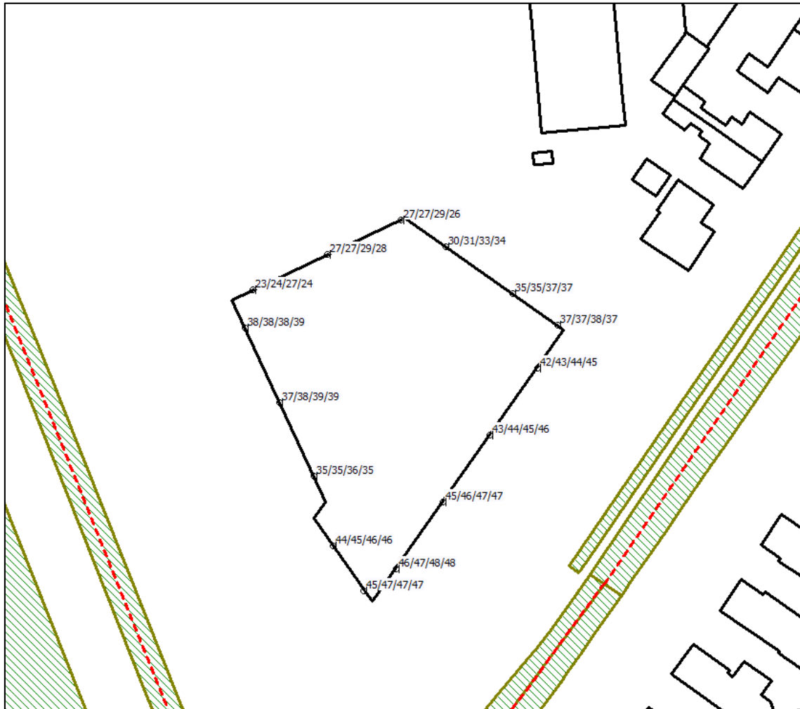
Figuur 5.2: overzicht van de berekende geluidbelasting L_{den} in dB vanwege de Torenlaan (inclusief 5 dB aftrek op basis van artikel 110g Wgh)
