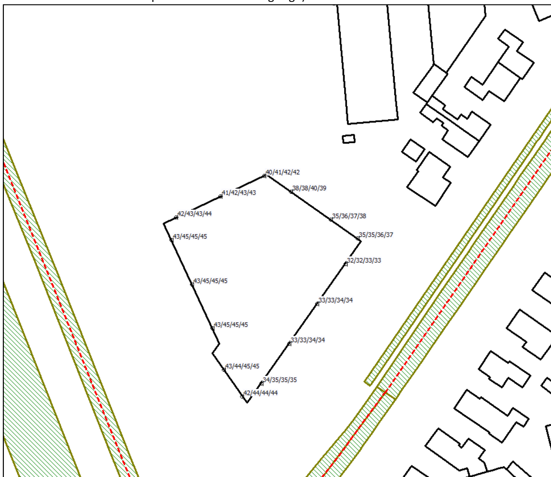
Figuur 5.3: overzicht van de berekende geluidbelasting L_{den} in dB vanwege De Omloop (inclusief 5 dB aftrek op basis van artikel 110g Wgh)
