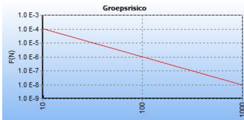
Figuur 5.3: fN-curve van het berekende groepsrisico met de oriëntatiewaarde (rode lijn)
