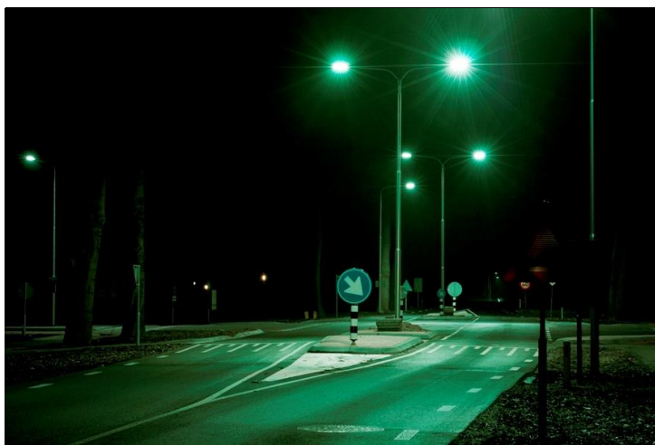
Figuur 6.3 Voorbeeld kruispunt voorzien van LED oriëntatieverlichting
