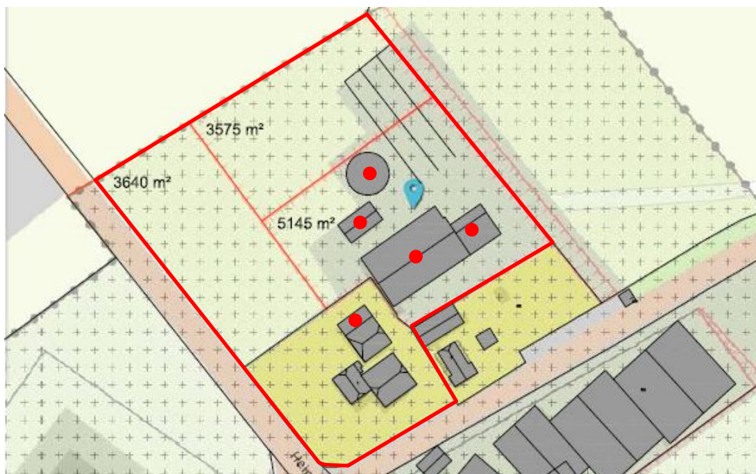
Afbeelding 16: bestaande situatie met te slopen gebouwen en opstallen met rode stip (Bron: bouwkundig ontwerp bureau Muntinga, 2014)
