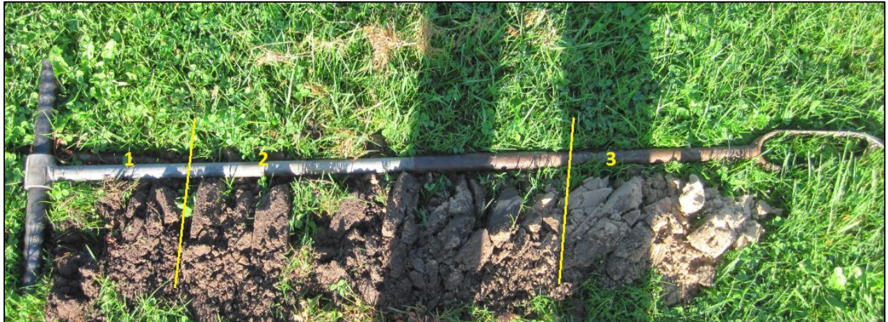
Afbeelding 15. Foto van boring 1, met de bodemlagen aangegeven met de gele lijnen en cijfers. 1: humeuze toplaag (graszode), 2: humeus puinhoudend pakket, 3: dekzand C-horizont
