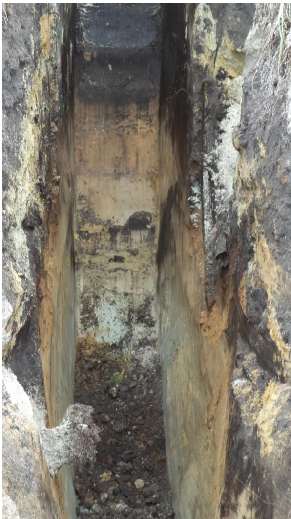
Foto10: betonverharding op ca. 3.2 m-mv in S145
