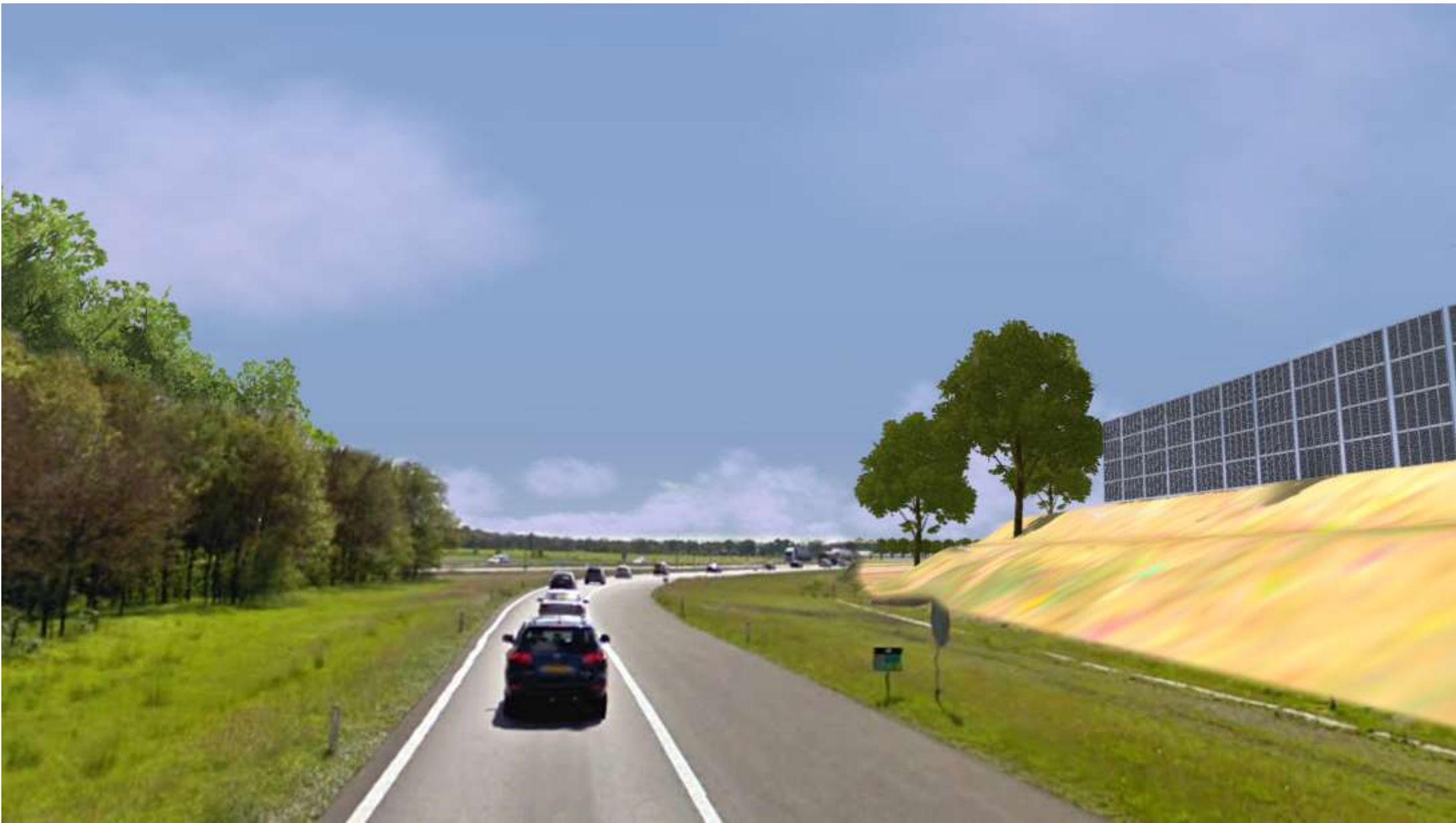
Figuur 44 - Zonnepanelen gebruiken als geluidsschermen
